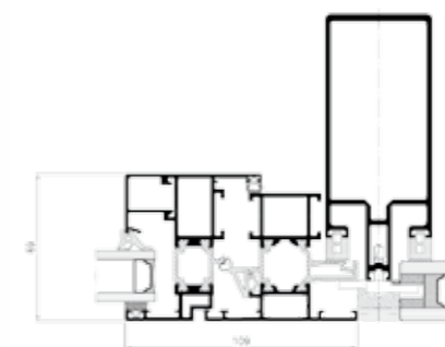
okno otváracé vo fasáde - rez
